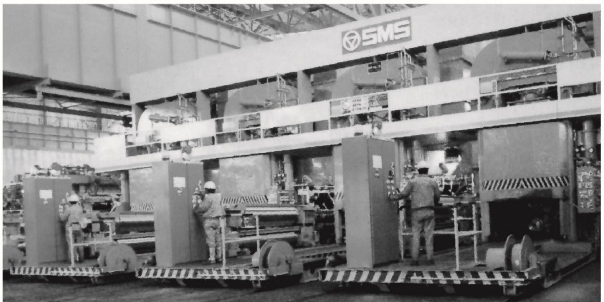
Рисунок 1.15 – Неперервний стан – тандем з пристроями для перевалки валків
