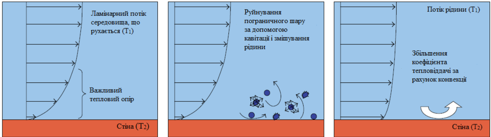
Типовий пограничний шар швидкості
