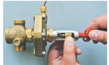
Рис. 15 – Метод налаштування регулятора
