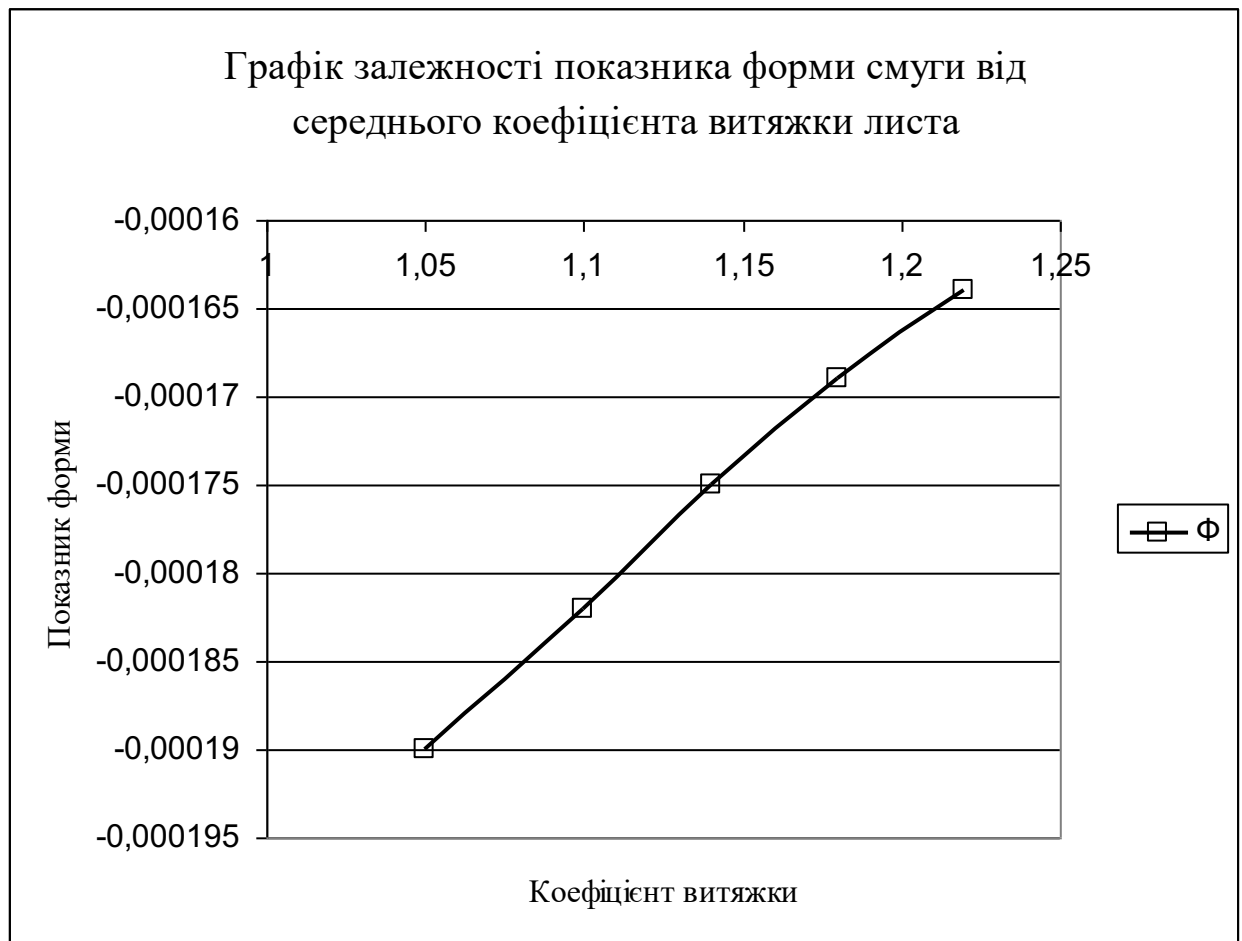
Рисунок 3.19 – Графік залежності показника форми штаби від середнього коефіцієнта витяжки листа при переході від плоского до хвилястого листа
