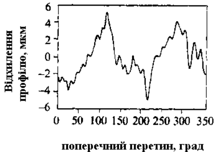
Рис. 2.6. Відхилення профілю поперечного перетину поверхні підшипникової труби розміром 81×8,1 мм
