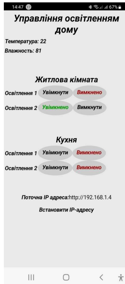
Рисунок 3.10 – Android додаток включення (виключення) світла та відображення температури та вологості в кімнаті
