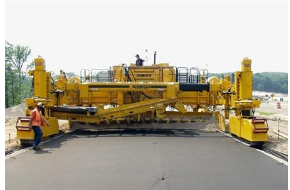
Рисунок 2.7 - Гусеничний бетоноукладач з розподільним гвинтовим механізмом і перевантажувальним конвеєром
