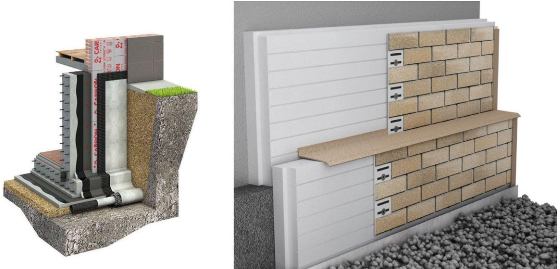
Рисунок 1.7 - Утеплення цоколю будівлі
