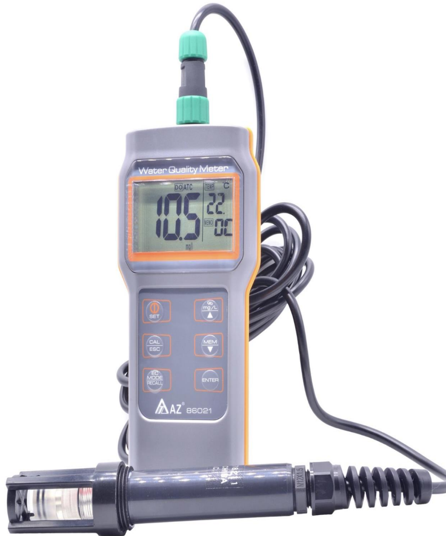
Рисунок 2.3 – Оксиметр AZ-86021 (DO) для вимірювання рівня кисню в періодично існуючих водоймах району дослідження.
