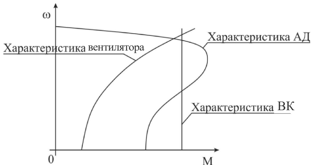
Рисунок 3.1 – Механічні характеристики вентилятора і АД
