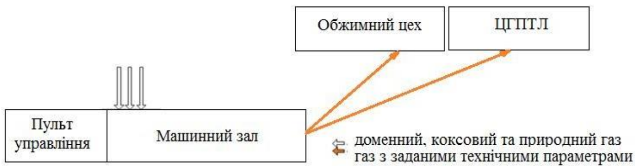
Рисунок 1.3 – Схема подачі змішаного газу
