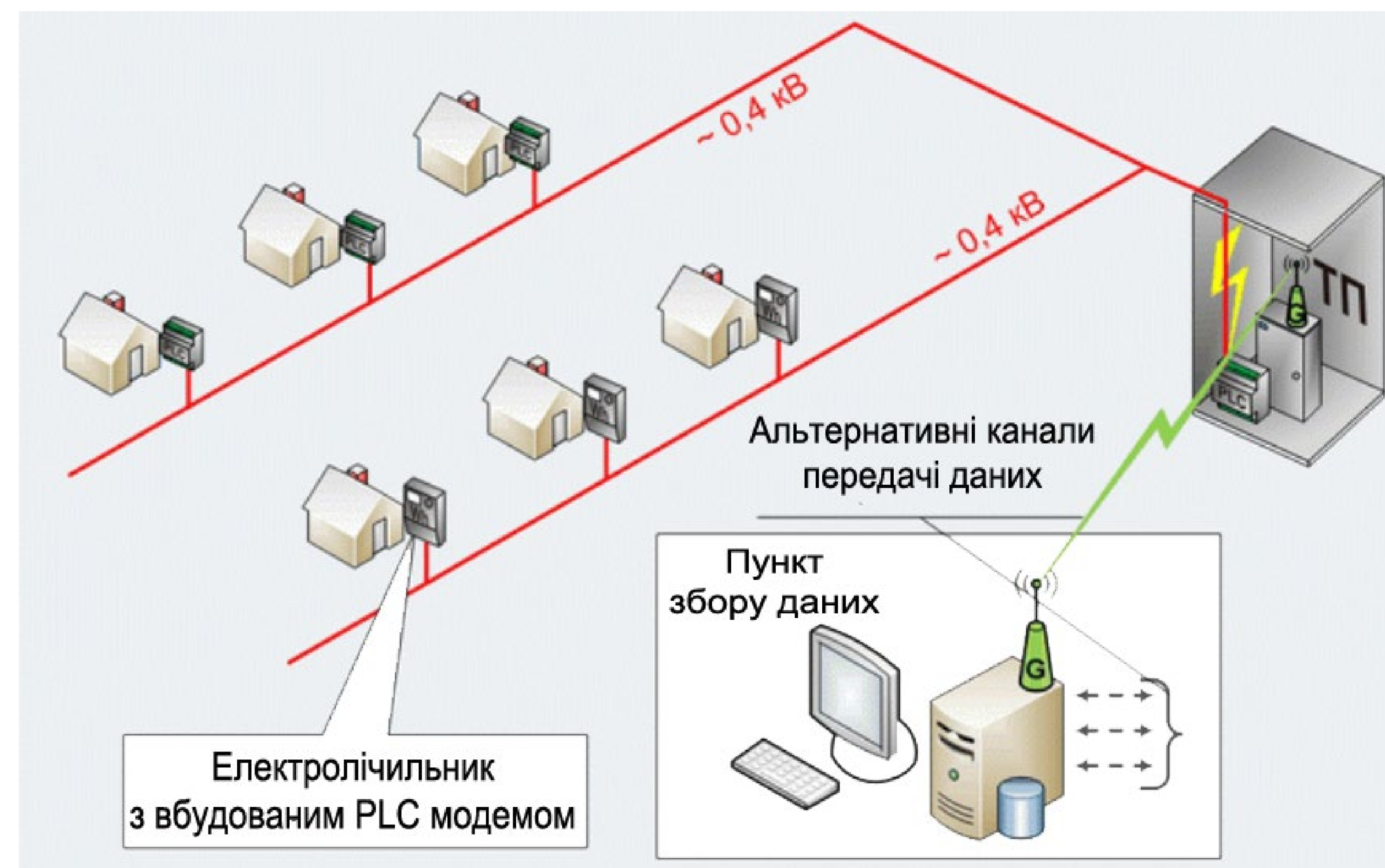
Структура автоматизованої системи контролю та обліку електроенергії з передачею інформації через GSM
