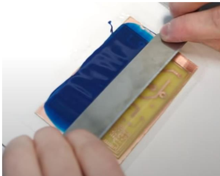
Рисунок 4.13 – Нанесення паяльної маски на плату.
