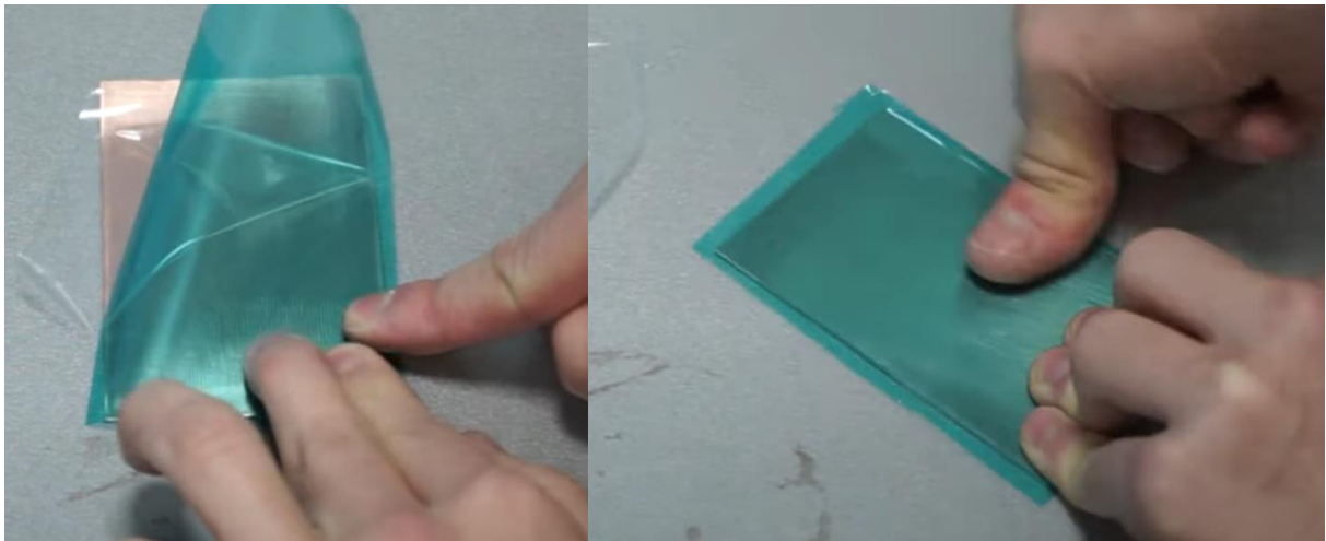
Рисунок 4.6 – Процес наклеювання фоторезисту на текстоліт.
