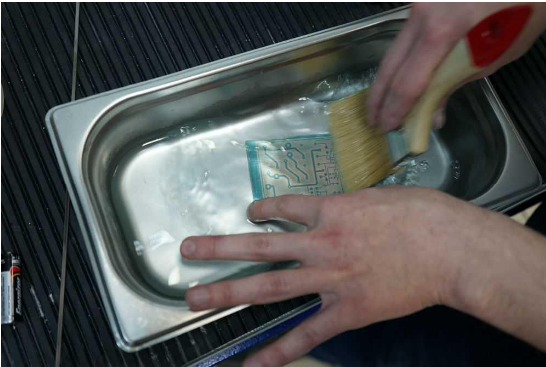
Рисунок 4.8 – Процес проявлення в розчині лугу.
