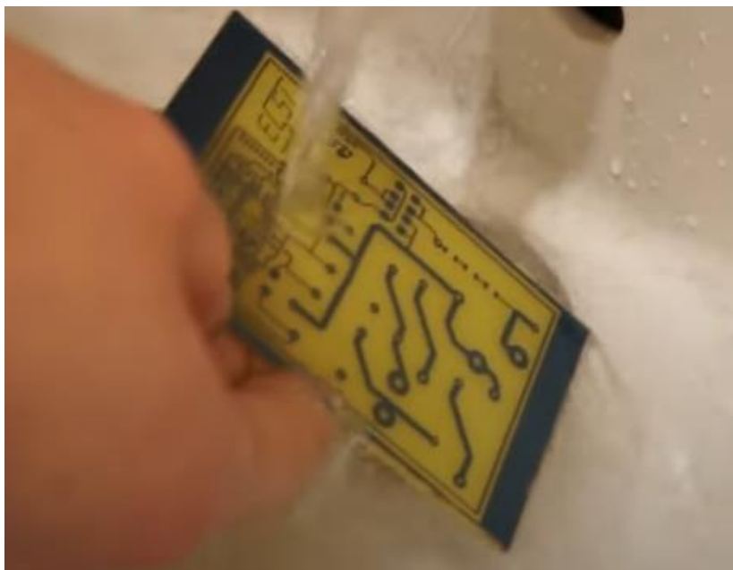
Рисунок 4.11 – Процес змивання хлорного заліза водою.
