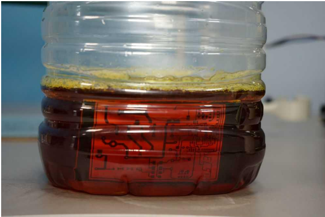
Рисунок 4.10 – Процес травлення плати у розчині хлорного заліза.
