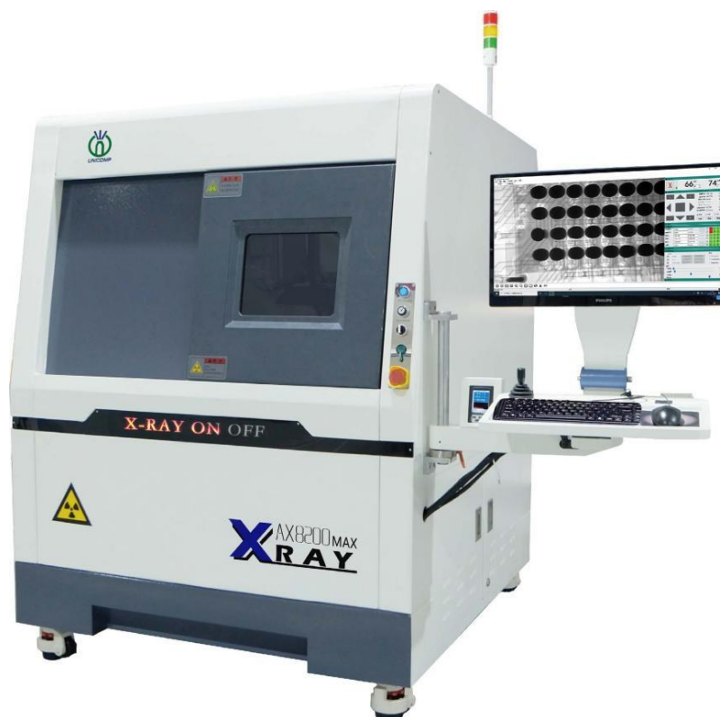
Рисунок 4.1 – Обладнання для рентген контролю друкованих плат.
