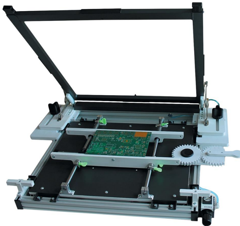
Рисунок 4.2 – Ручний трафаретний принтер для друкованих плат.
