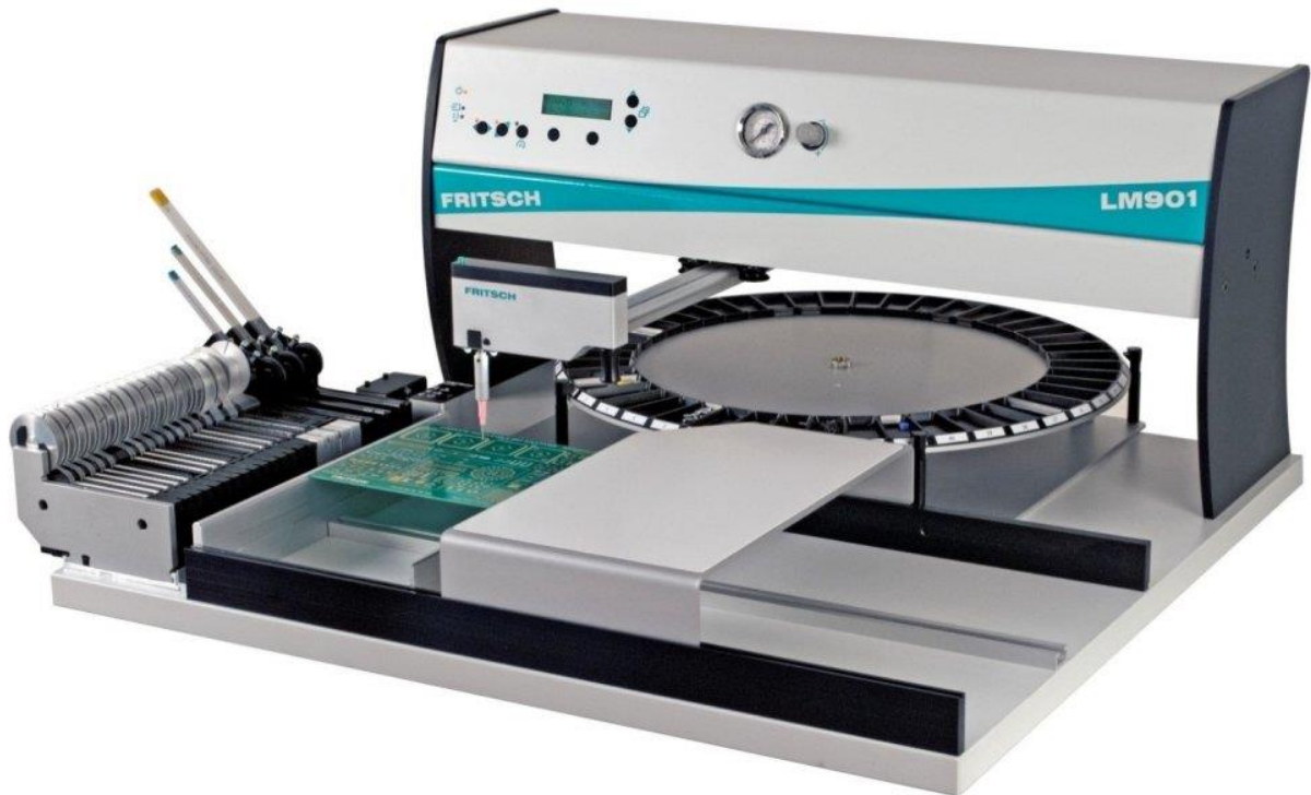
Рисунок 4.3 – Верстат для автоматичного встановлення SMD компонентів на друковану плату.
