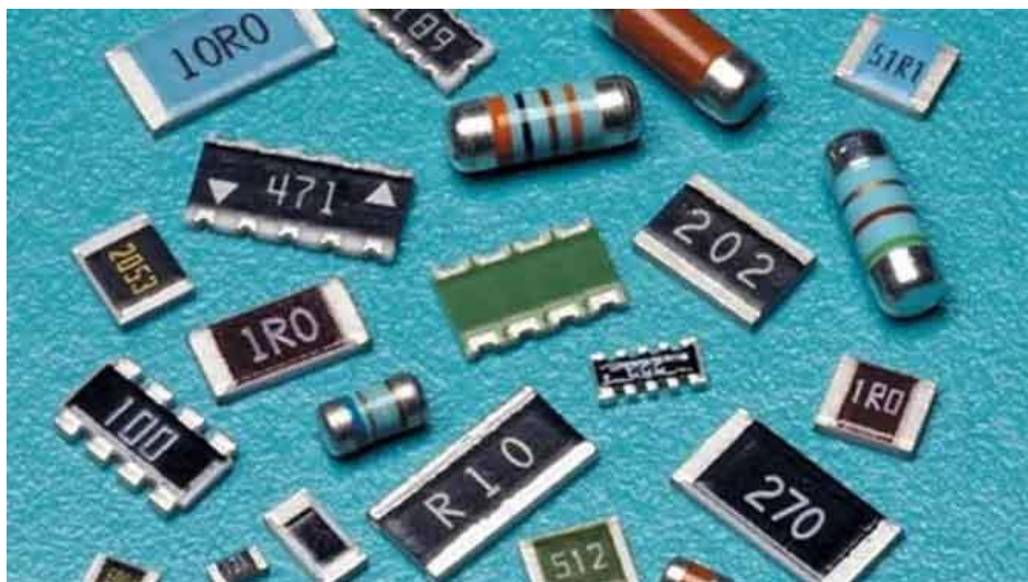
Рисунок 4.8 – SMD – компоненти з контактами на бічній частині корпусу.
