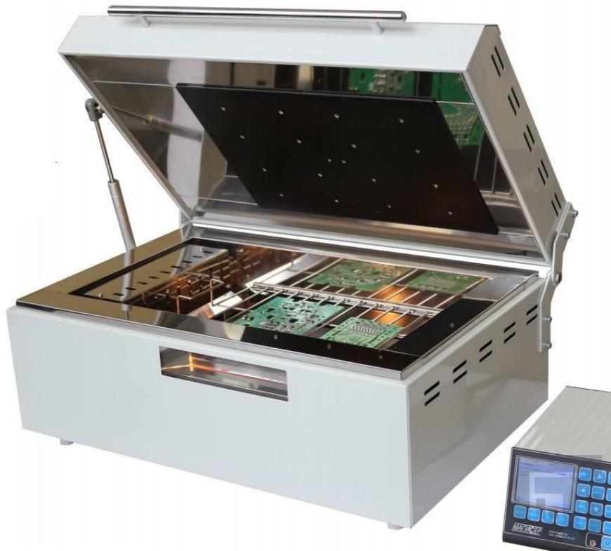
Рисунок 4.4 – Конвекційна піч для оплавлення припою.
