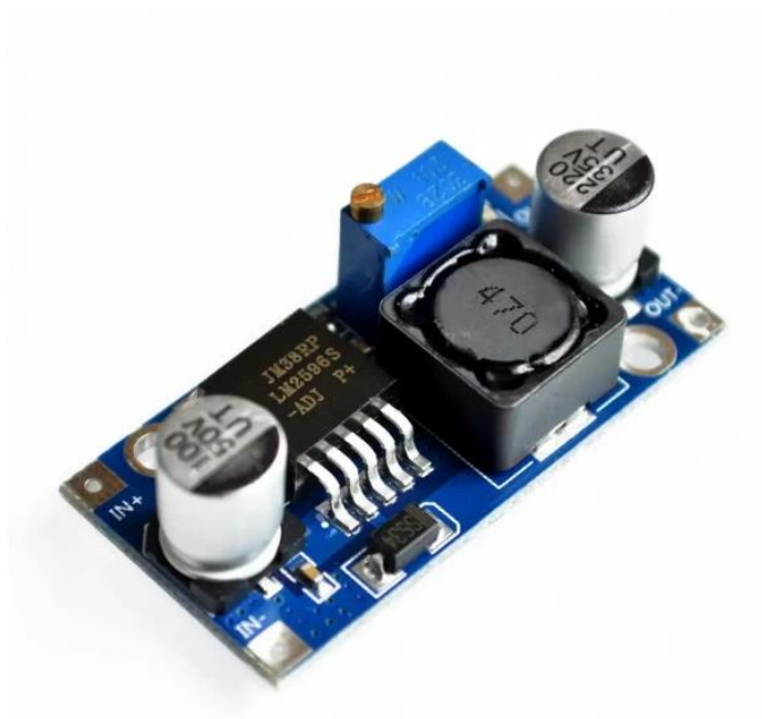
Рисунок 1.1 - Перетворювач першого роду на мікросхемі LM2596.
