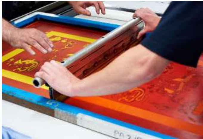
Рис.12. Процес трафаретного друку у сучасних поліграфічних підприємствах
