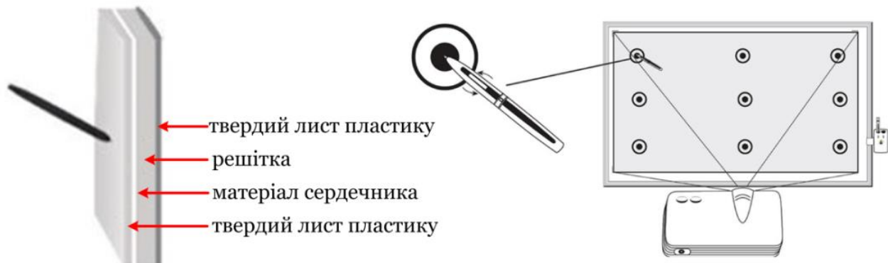
Рис. 2.8. Принцип роботи дошки за електромагнітною технологією
