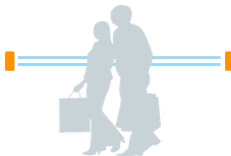
Рисунок 3.8 – Принцип роботи інфрачервоного (ІЧ) лічильника
