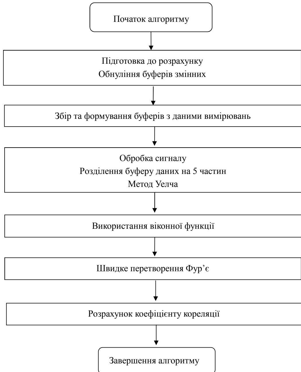
Рисунок 8.3 – Блок-схема алгоритму розрахунку коефіцієнту кореляції
