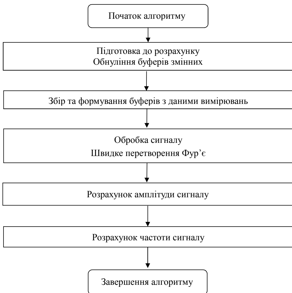
Рисунок 8.2 – Блок-схема алгоритму розрахунку СХ
