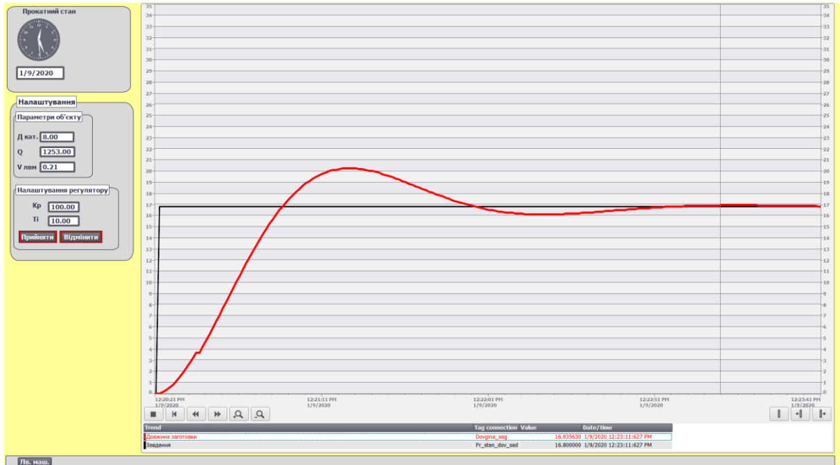
Рисунок 4.48 – Зміна довжини заготовки в часі при V = 12,6 \text{ м/хв } (0,21 \text{ м/с}) .
