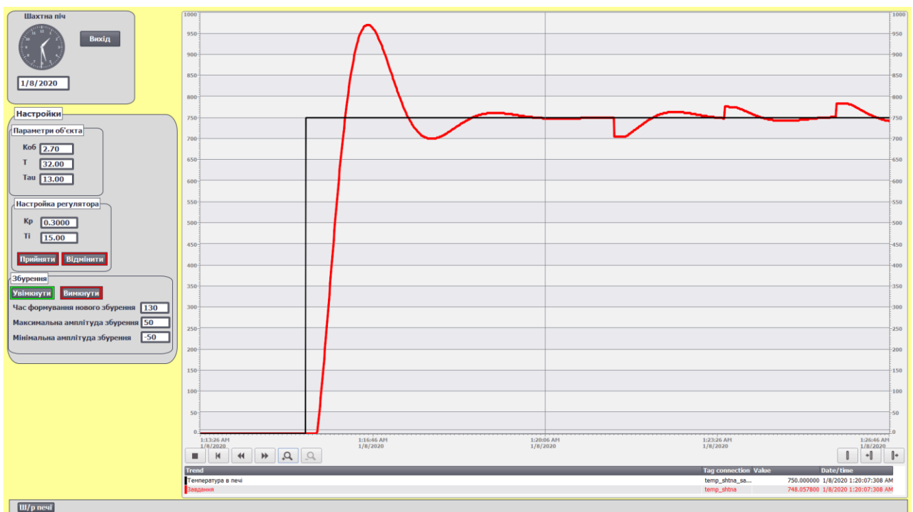
Рисунок 5.7 – Графік температури шахтній печі при увімкнених збуреннях.
