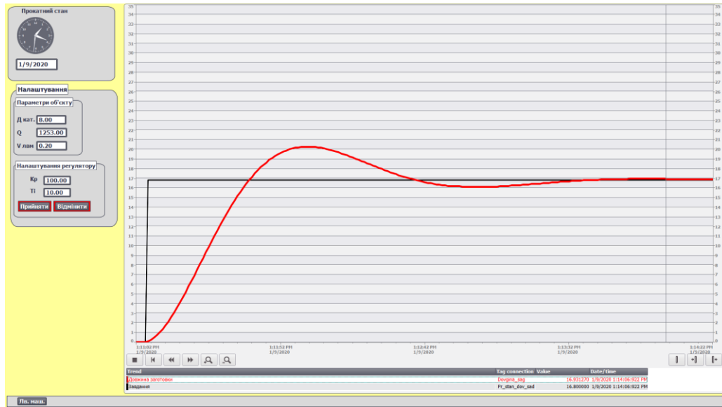
Рисунок 4.53 – Зміна кількості теплоти в часі при T_{\text{роз}} = 700^\circ\text{C} .
