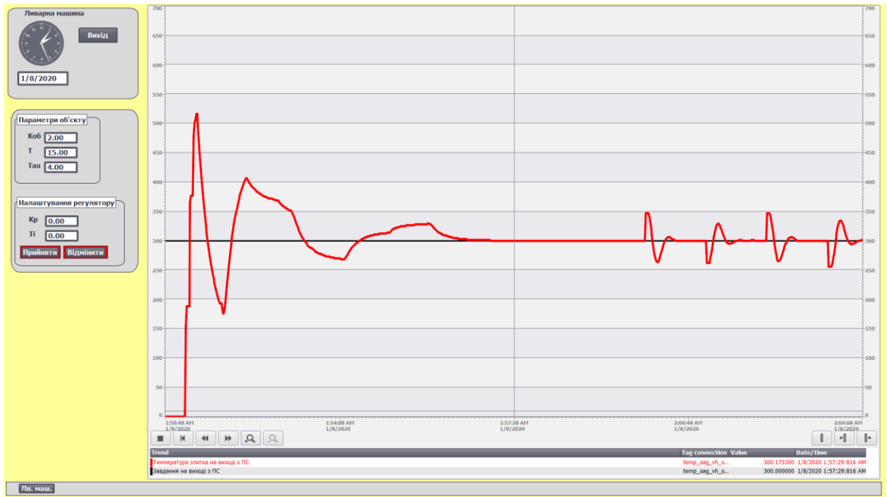
Рисунок 5.14 – Зміна температури заготовки на виході прокатного стану.
