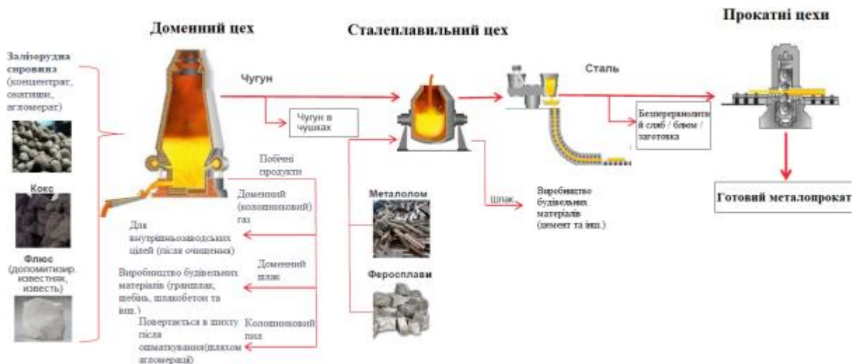
Рис.2.2 – Технологія виробництва ТОВ «МЕТІНВЕСТ ХОЛДІНГ»
