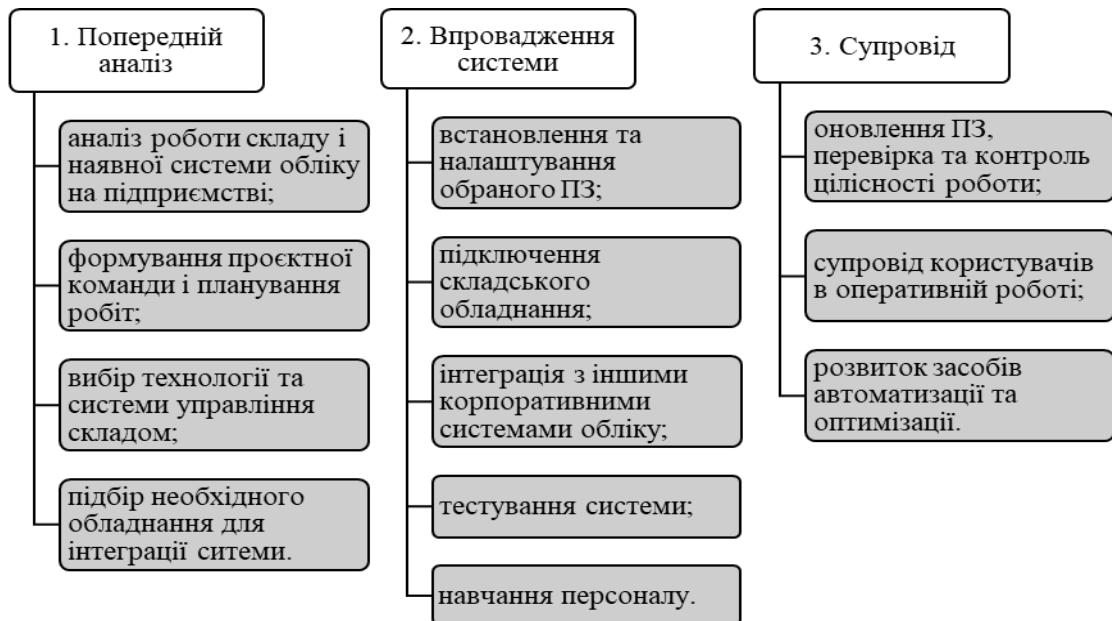
Рисунок 3.2 – Етапи впровадження автоматизованої системи управління складом WMS
