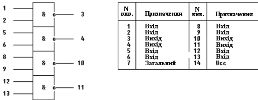
Рисунок 2.13 - Логічна модель мікросхеми К561ЛА7
