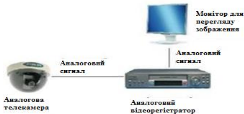
Рисунок 1.1 – Схема конструкції аналогової системи відеоспостереження
