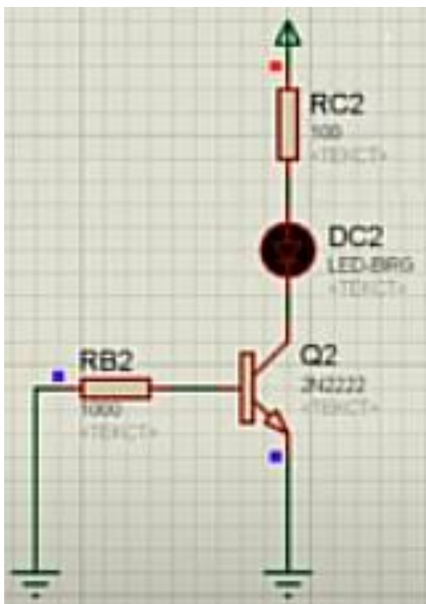
Рисунок 2.11 – Схема виконавчого вузла електронного цифрового таймера в редакторі Proteus
