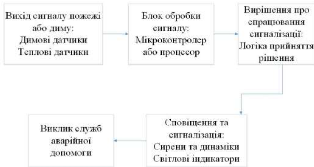
Рисунок 1.8 - Структурна схема пожежного сповіщувача
