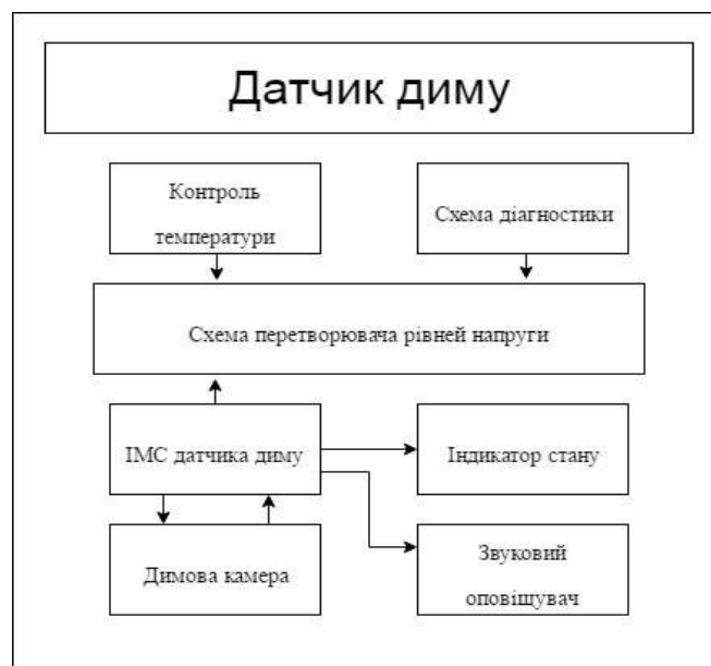
Рисунок 1.1- Загальна блок схема датчику диму
