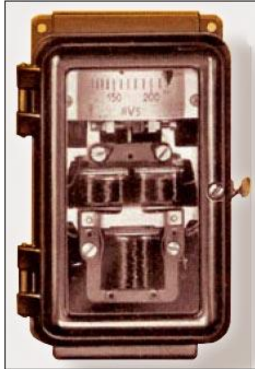
Рисунок 2.1 – Реле підвищення напруги типу RV5, (Siemens, 1936)
