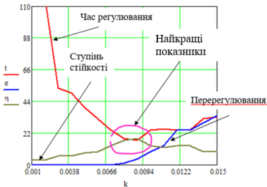
Рисунок 3.9 – Графіки залежності показників якості перехідного процесу в системі автоматичного регулювання від коефіцієнту підсилення
