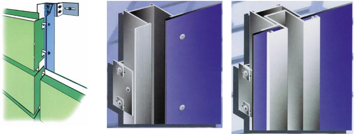
Рисунок 1.4 - Варіанти кріплення облицювань: касетний спосіб(система MIRASYSTEM; за допомогою заклепок (система U - kon); за допомогою накладної планки(система U - kon).
