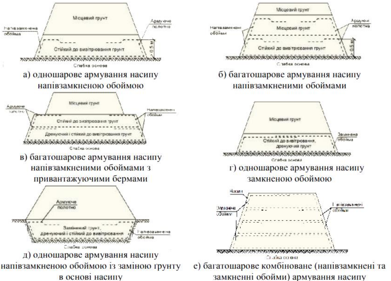
Рисунок 1.3 - Способи армування насипів на слабких основах геосинтетичними матеріалами з улаштуванням обійм
