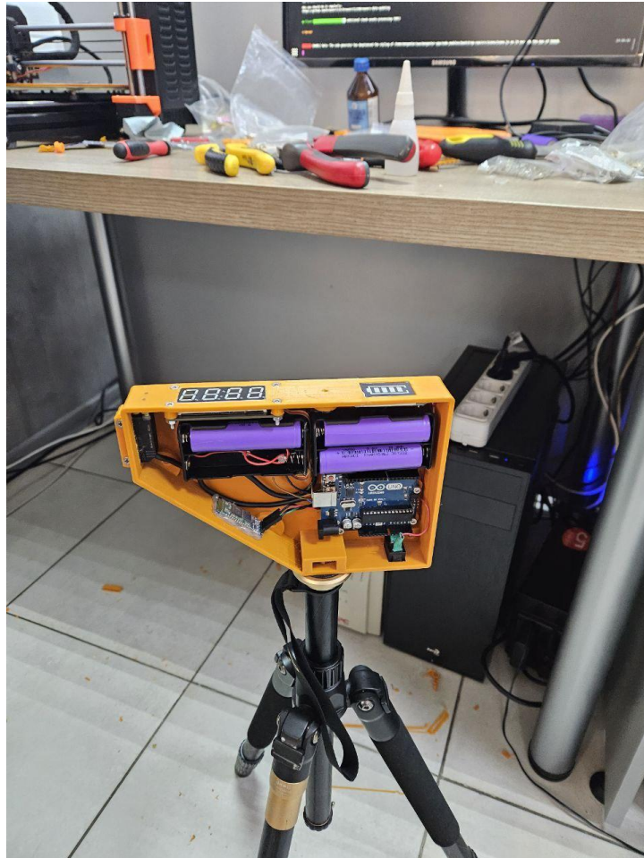
Рисунок 4.6 — Конструкція контейнеру Arduino з середини.
