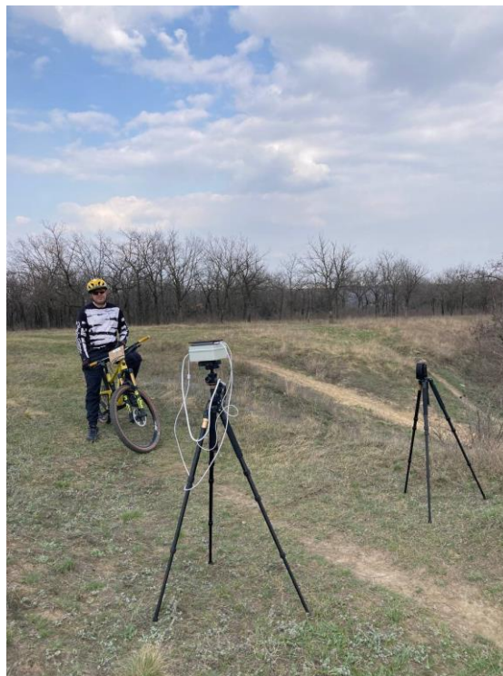
Рисунок 4.3 — Конструкція воріт з використанням TRX-100M/4CH
