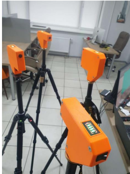
Рисунок 4.5 — Третя ітерація конструкції старту воріт.
