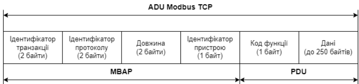
Рисунок 4.1 — Формат фрагменту фрейму Modbus TCP, що зберігається в полі даних пакету TCP
