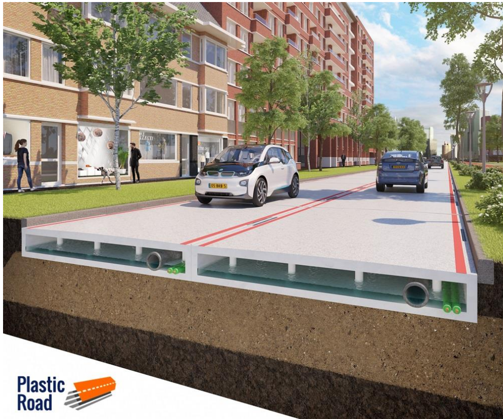
Рисунок 3.9 – PlasticRoad – дорога з відпрацьованого пластику
