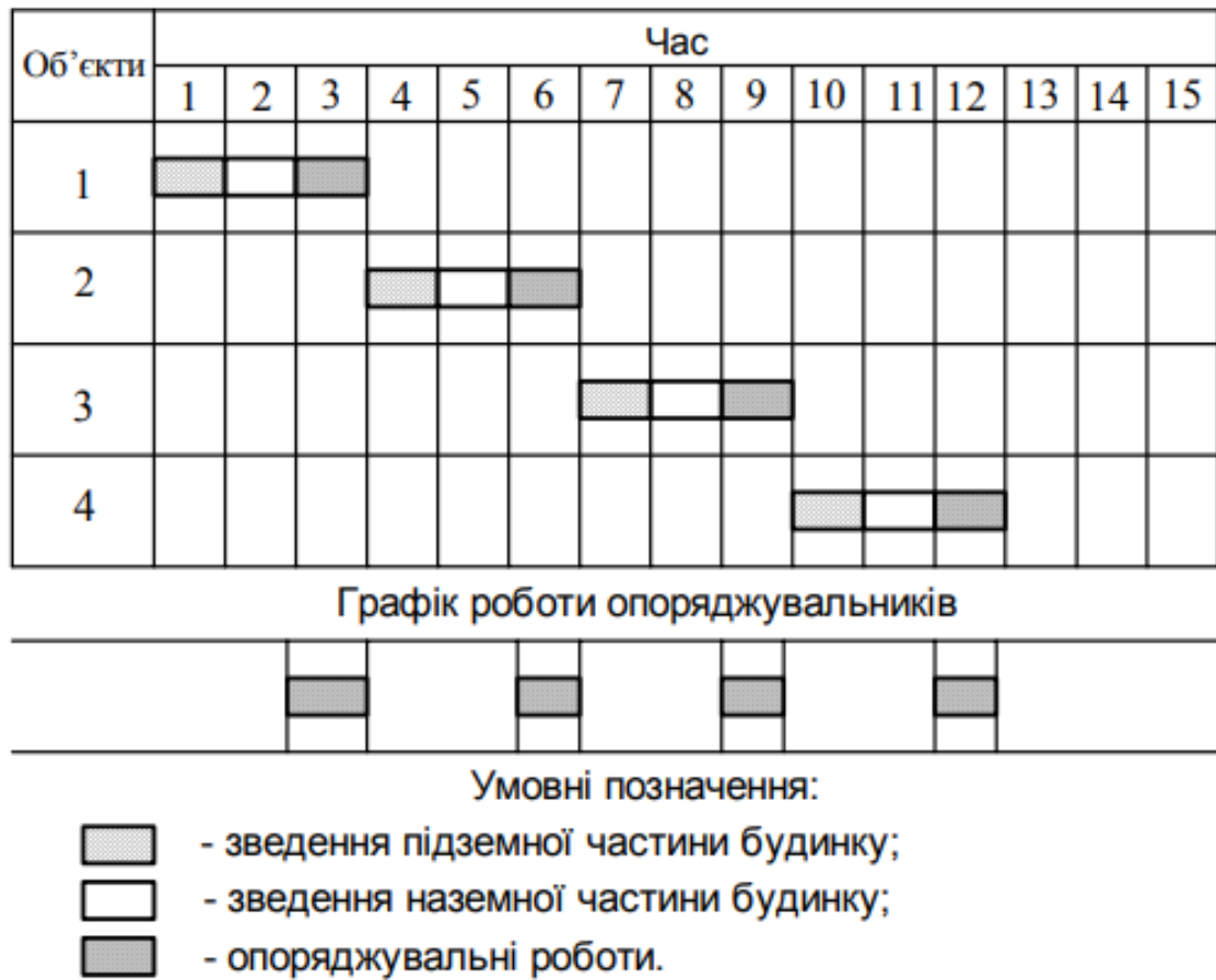
Рисунок 1.2. Графік будівництва об'єктів при послідовному методі роботи бригад
