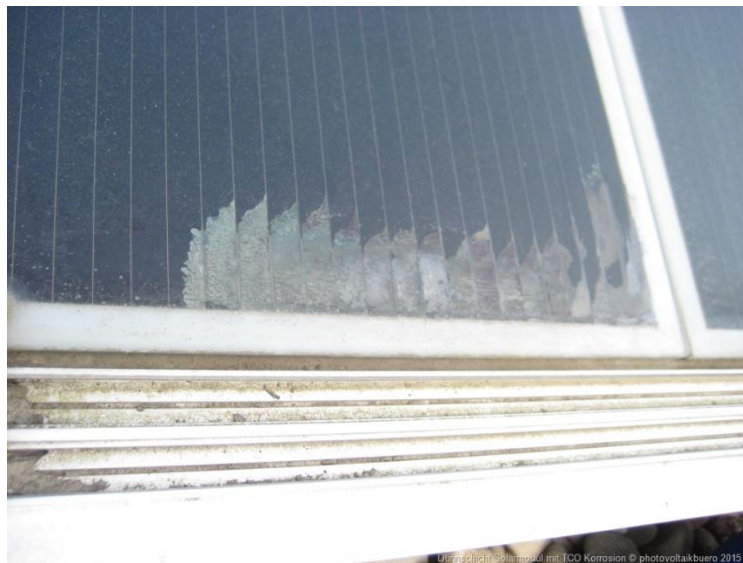
Рисунок 2.7 - Тонкоплівковий сонячний модуль з незворотним ефектом PID. TCO корозія
