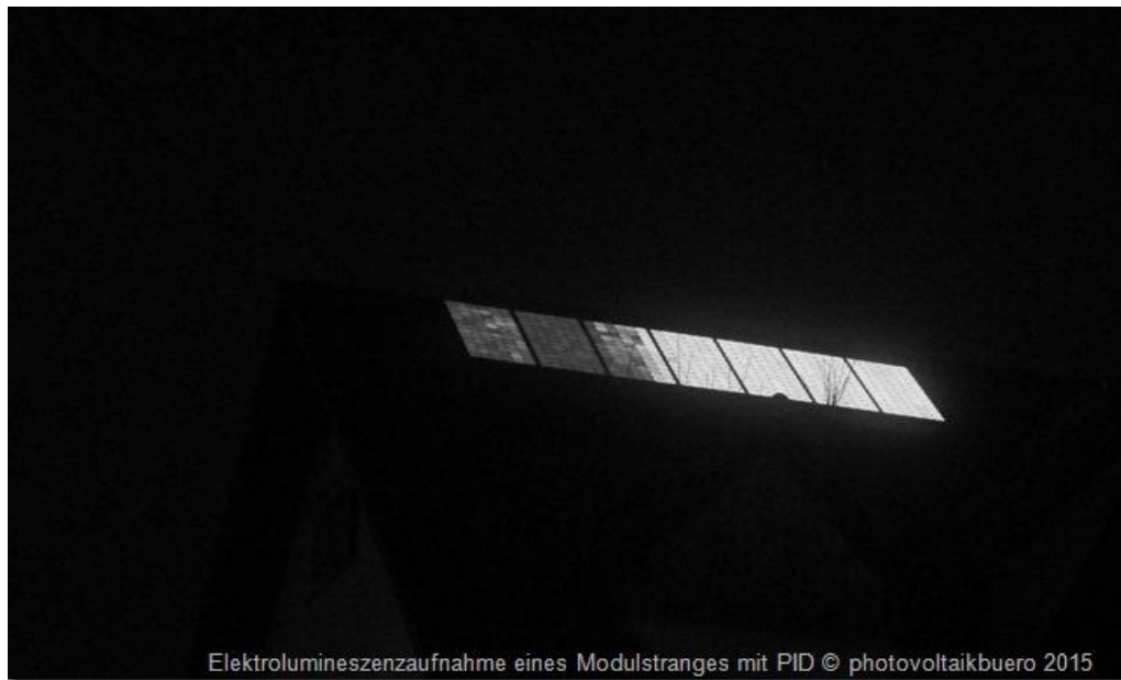
Рисунок 2.2 - Викликана потенціалом деградація на PV панелях
