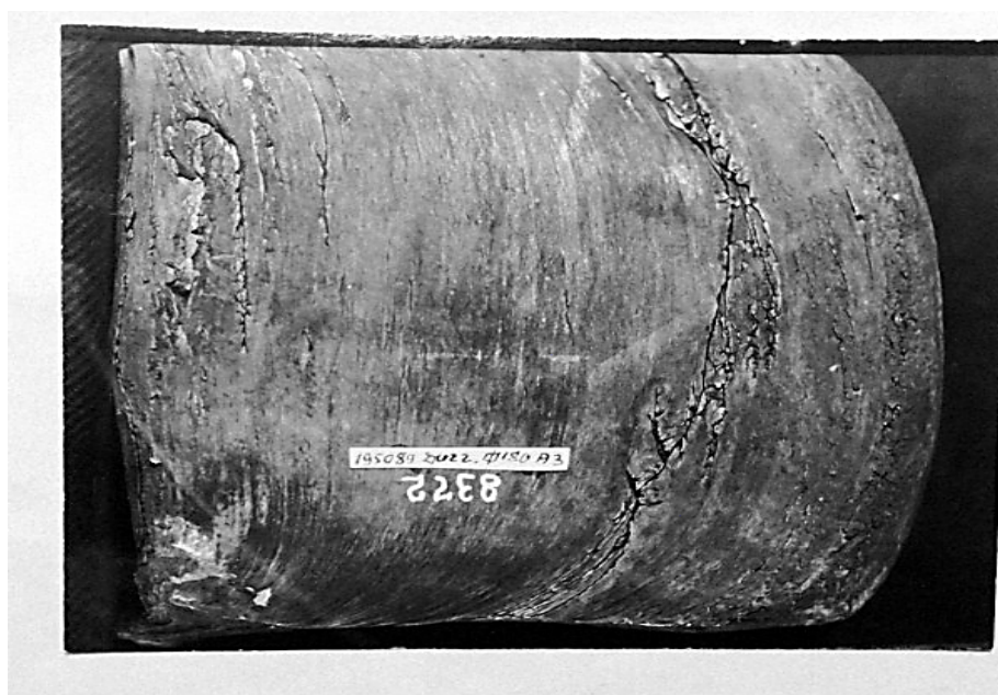
Рисунок 1.2 – Рванини, що утворилися на межі розкату на заготівлі зі сталі 4Х4М2ВФС
