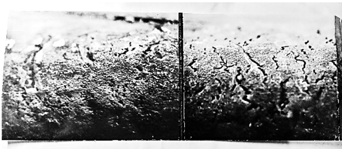
Рисунок 3.3 – Кутові рванини на розкаті перетином 430x365мм сталі 4Х4М2ВФС.
