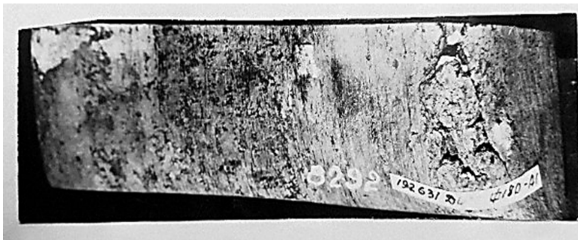
Рисунок 1.1 – Рванини, що утворилися на ребрах розкату на заготівлі зі сталі 4Х4М2ВФС
