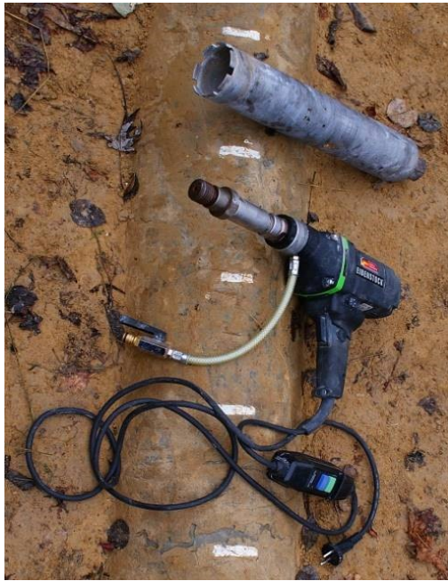
Рисунок 2.2 – Електроперфоратор з алмазною пустотілою коронкою
