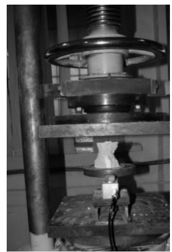
Рисунок 3.10 – Гідравлічний прес та зруйнований зразок
