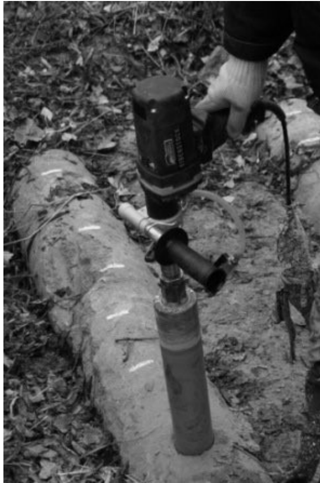
Рисунок 3.8 – Процес відбору монолітів із ГЦЕ
