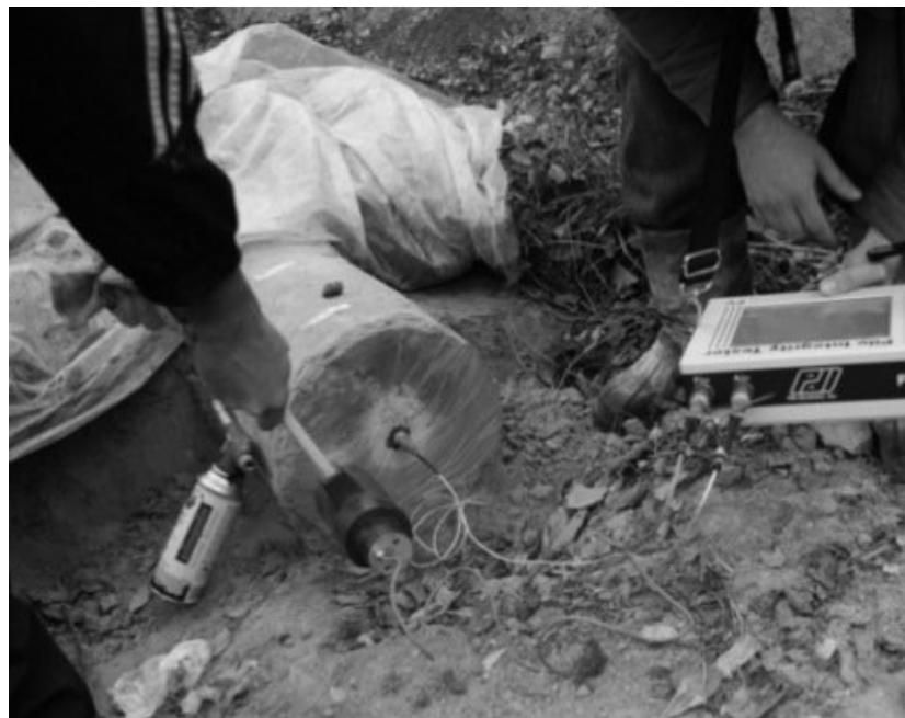
Рисунок 3.12 – Процес перевірки суцільності ГЦЕ
