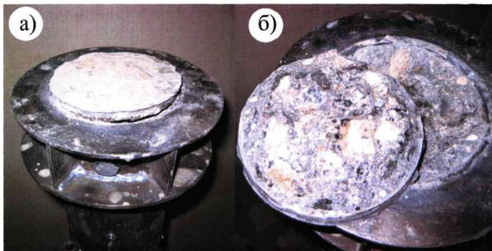
Рисунок 2.39 – Відкол верхнього шару бетонного ядра в дослідних зразках VII серії (Т102.АЦО \ B40.0,38): а - після випробувань; б - характер руйнування
