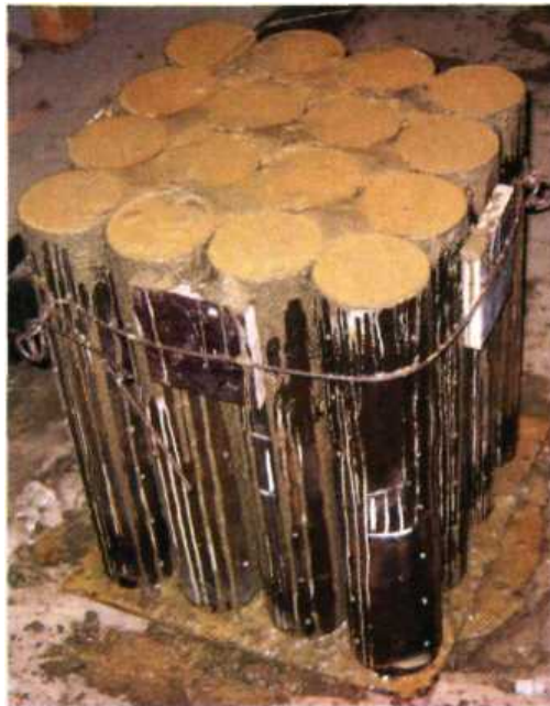
Рисунок 2.6 – Забетоновані зразки 1-У серій
