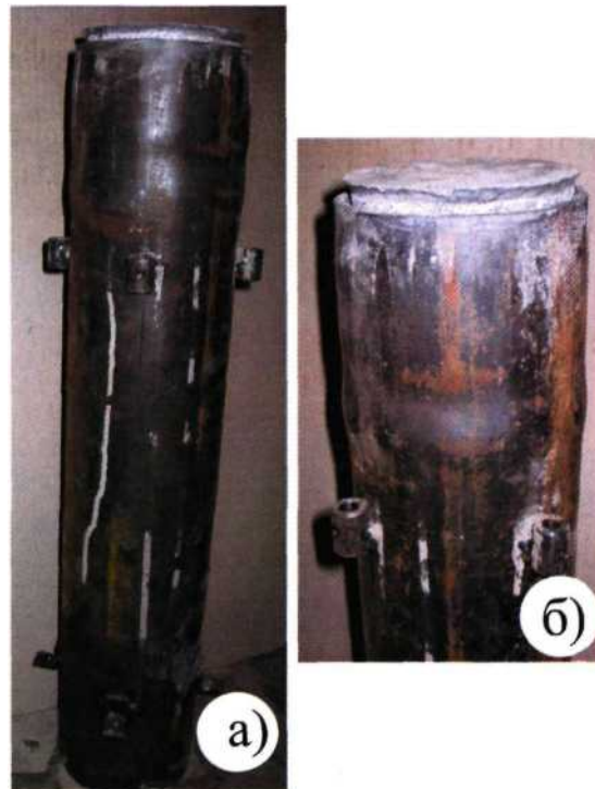
Рисунок 2.49 – Характер деформування досліджуваних трубобетонних зразків XI серії (ТЮ8.АЛО\ B55.0,26) після прикладання руйнівного навантаження на оболонку: а - загальний вигляд зразка; б - деформації оголовка
