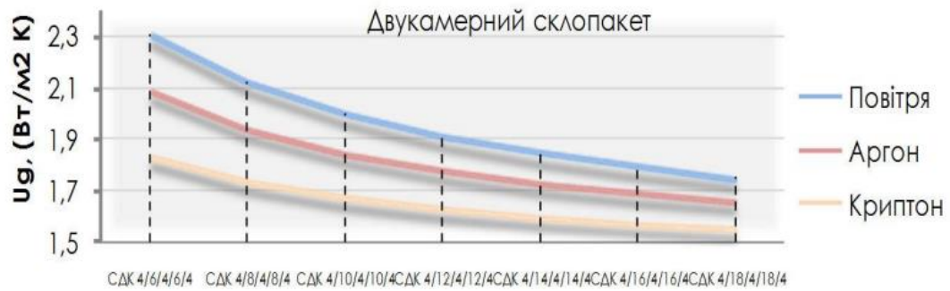
Рисунок 2.3 – Значення теплопередачі для двокамерних склопакетів
