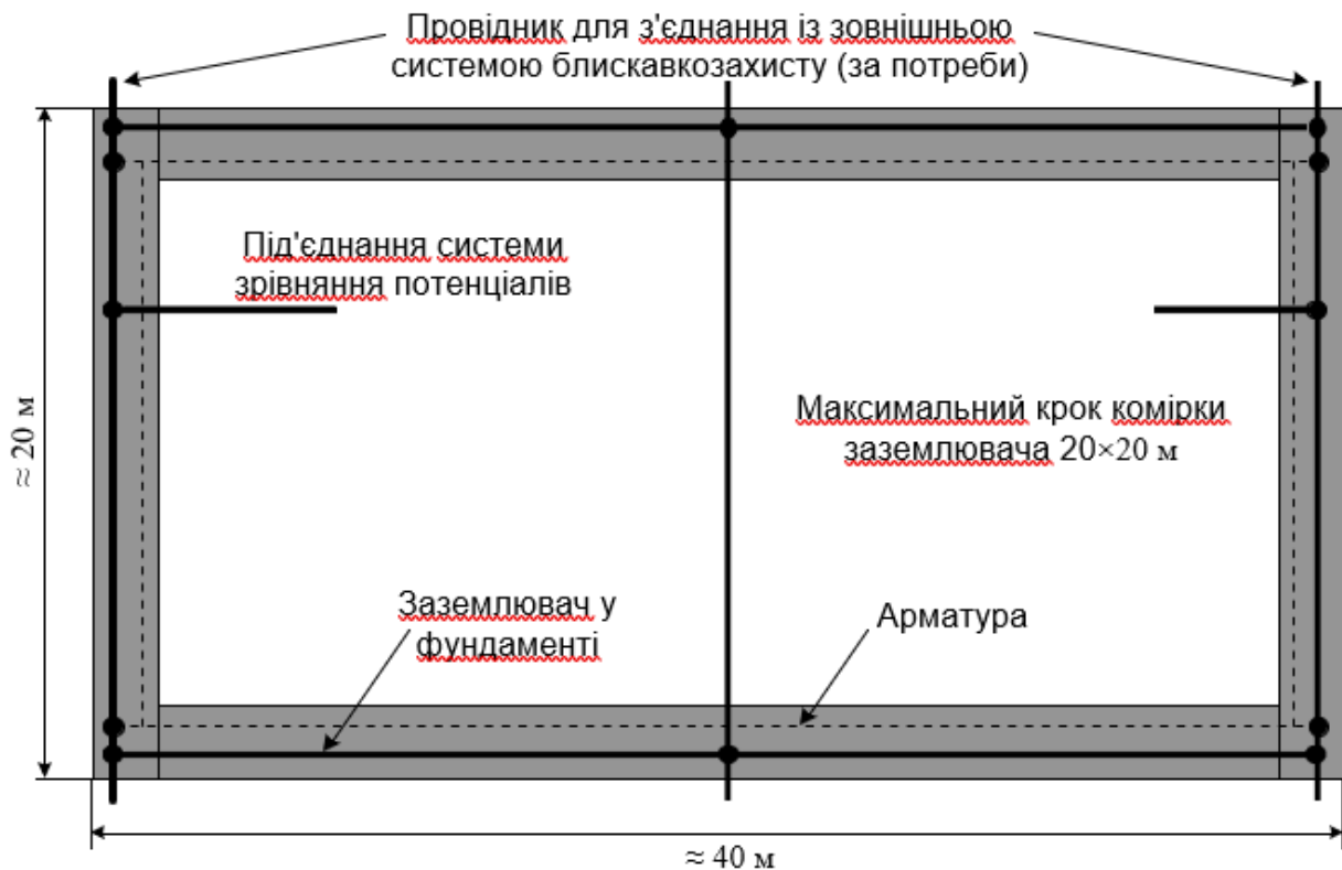
Рисунок 2.25 – Фундаментний заземлювач типу В
