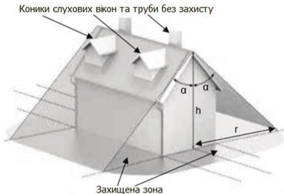
Рисунок 2.8 – Зона захисту блискавкоприймача на гребені даху
