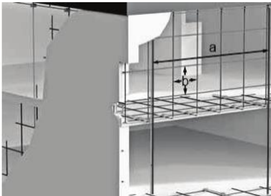
Рисунок 2.20 – Прокладення додаткових струмовідводів в бетонних стінах
