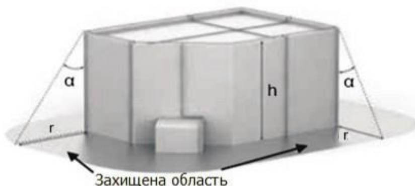
Рисунок 2.7 – Захисна зона блискавкоприймальної сітки
