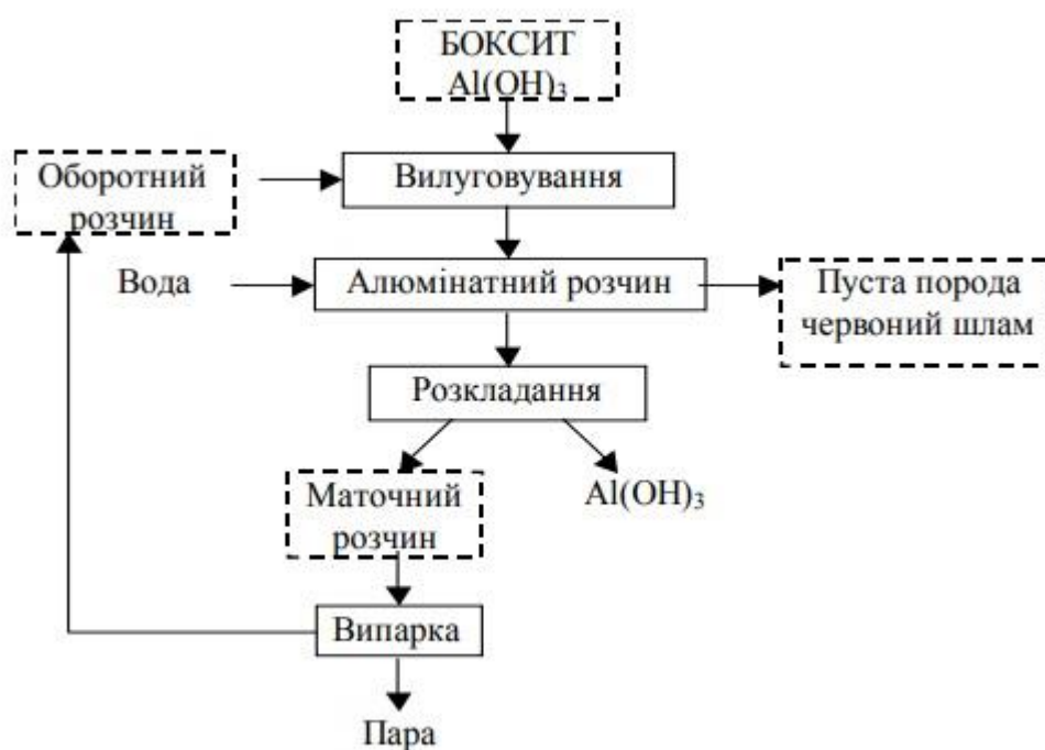
Рисунок 1.1 – Принципова схема отримання глинозему за методом Байєра
