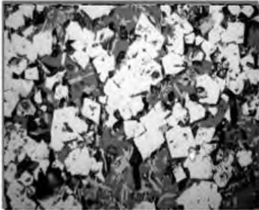
Рисунок 3.3 – Мікроструктура офлюсованого агломерату при заміні 30% концентрату залізною рудою. Магнетит – біле, скло фаза сіра, голчаті кристали ферита – світло-сірі. Відбите світло, x500
