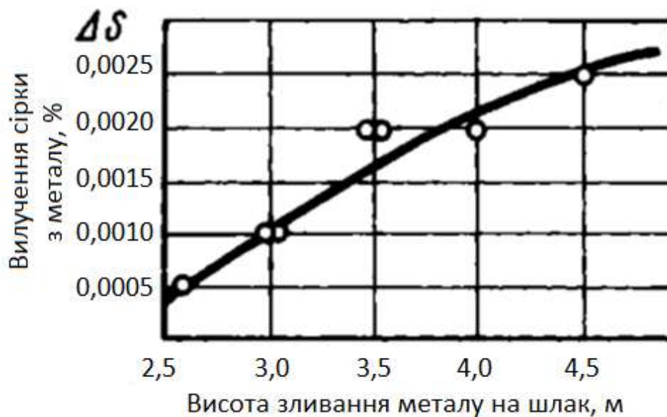
Рисунок 3.7 – Залежність кількості сірки, віддаленої зі сталі в процесі ЕШР, від висоти зливу металу на шлак
