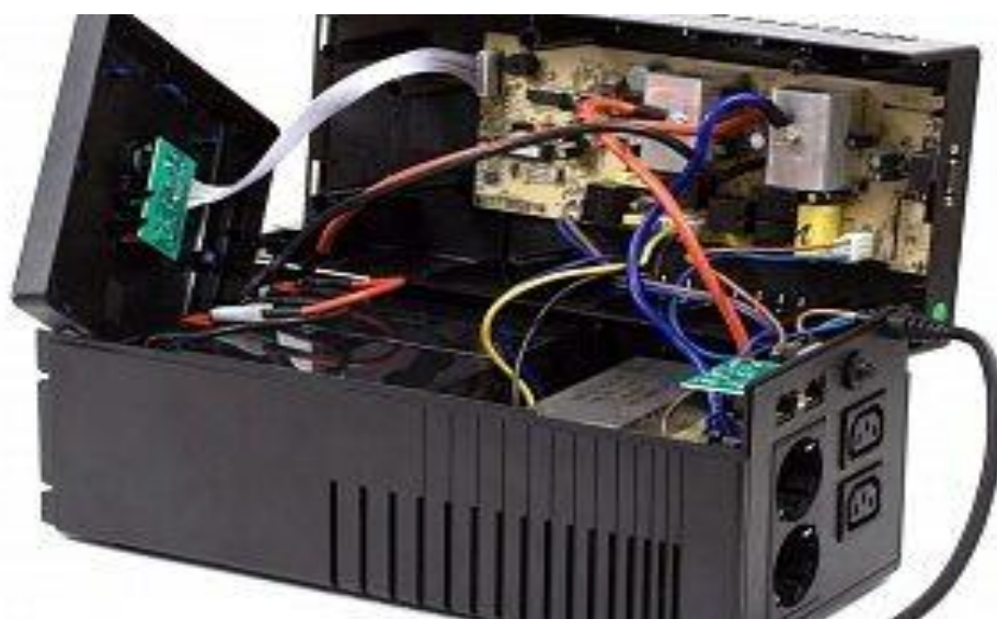
Рисунок 4.1 – Оптимальна орієнтація розташування блоків в ДБЖ
