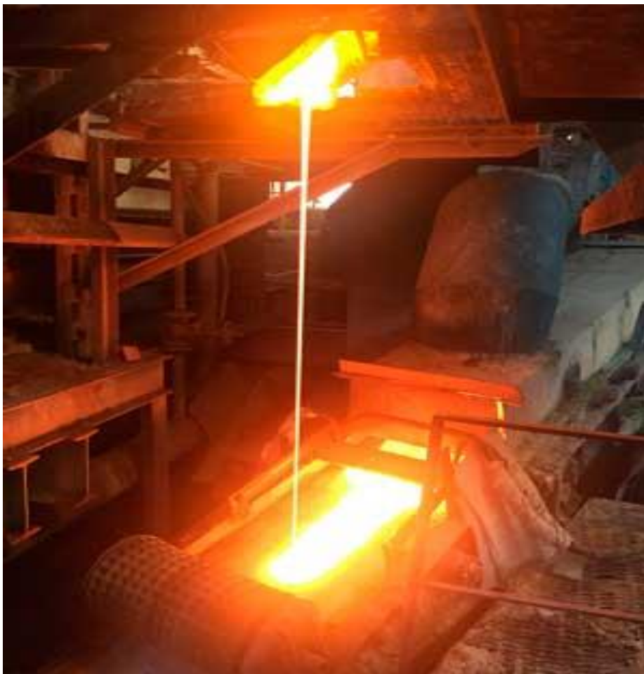
Рисунок 2.2 - Обладнання з виробництва зварювальних флюсів методом подвійного рафінування розплаву
