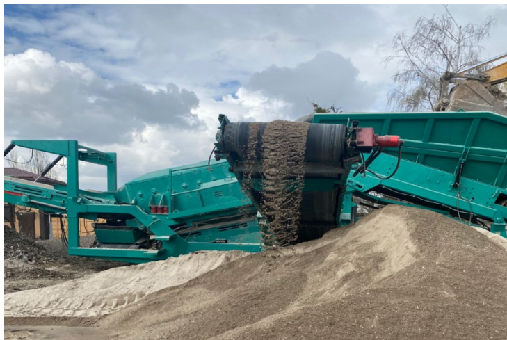
Рисунок 4.10 – Процес подрібнення будівельного сміття та перетворення його на новий будівельний матеріал
