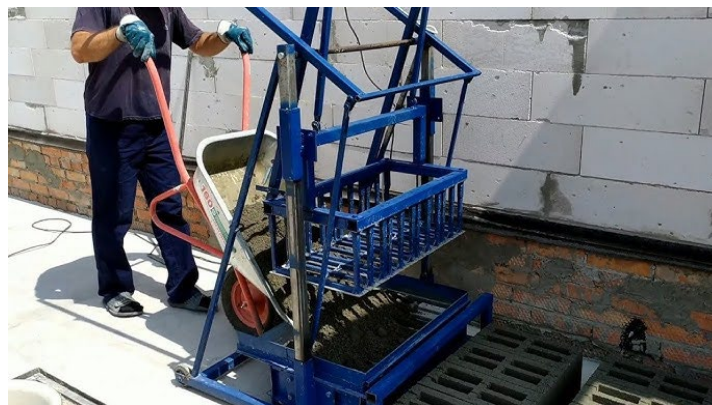
Рисунок 3.2 – Ручний верстат для виготовлення шлакоблоків
