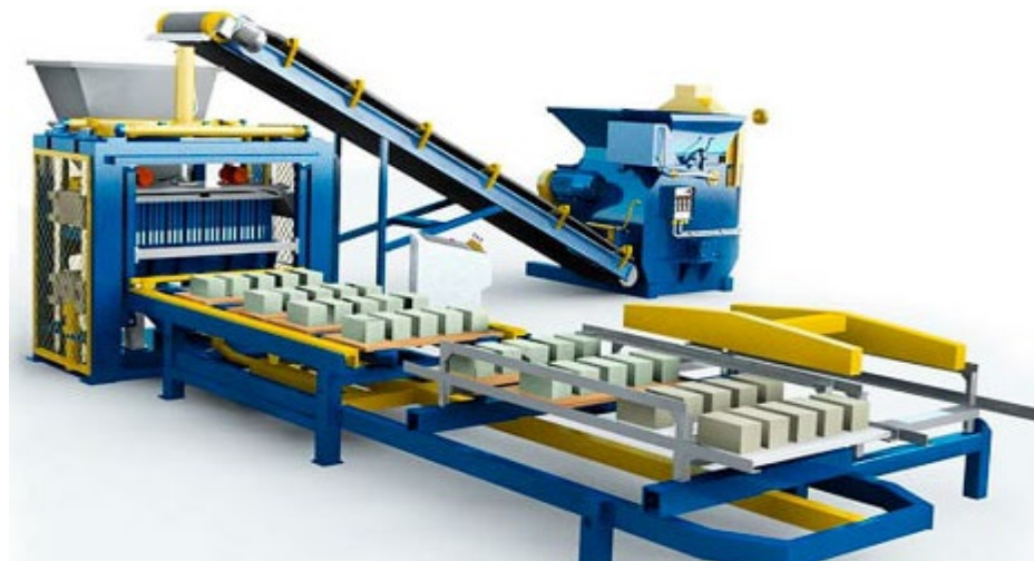
Рисунок 3.3 – Механічний верстат для виготовлення шлакоблоків
