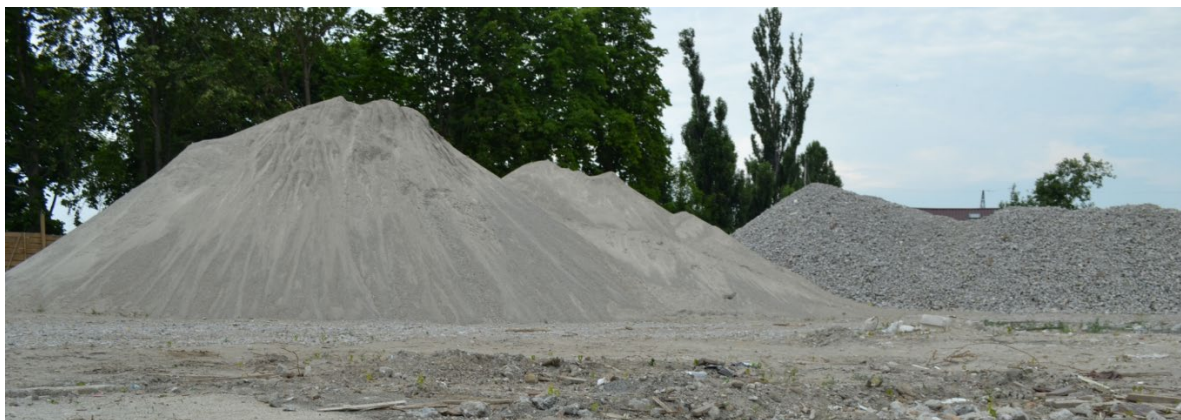
Рисунок 4.8 – Перероблені бетонні блоки, що склали залізобетонний каркас будинків.
