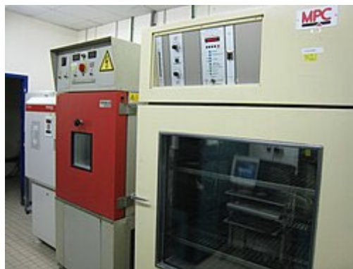
Рисунок 2.4 – Кліматична камера з автоматичним регулюванням температури і вологості
