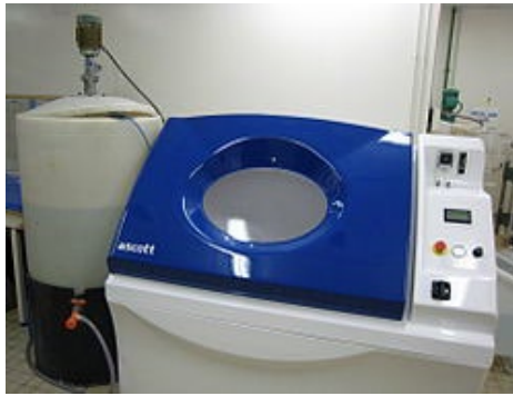
Рисунок 2.5 – Камера для випробувань у соляному тумані
