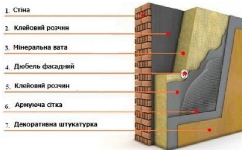
Рисунок 2.9 – Схема утеплення фасаду мінеральною ватою
