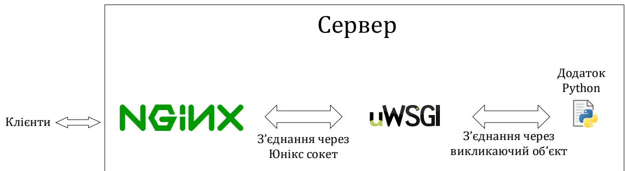
Рисунок 2.1 – Сервер з uWSGI інтегрований до Nginx
