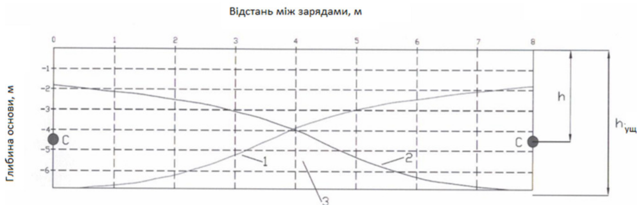
1 – зона розрідження ґрунту від вибуху першого заряду; 2 – те саме, другого заряду; 3 – «мертва зона», не схильна до розрідження ґрунту основи Рисунок 3.1 – Характер зон розрідження ґрунту при послідовному вибуху двох поруч розташованих зарядів з \Delta t \geq t_{ущ}
