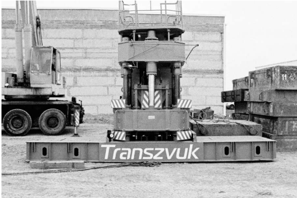
Рисунок 1.12 – Палевдавлювальна машина СЮ-450
