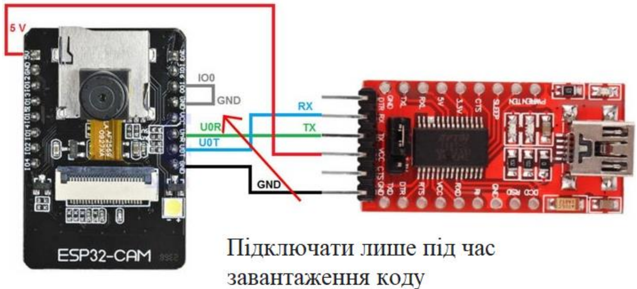
Рисунок 2.5 – Схема з'єднання ESP32-CAM та FTDI
