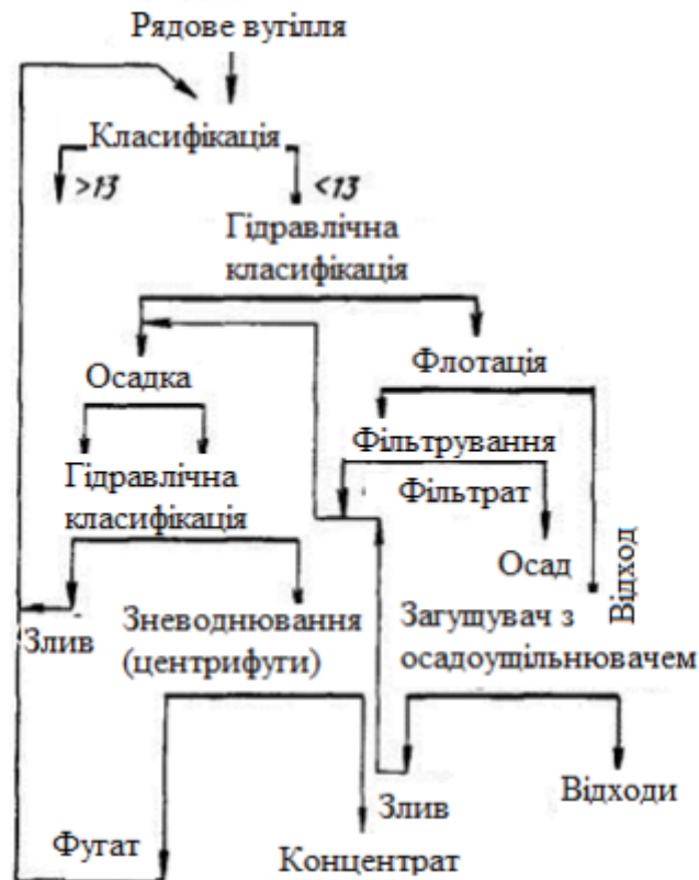
Рисунок 1.2 – Раціональна водно-шламова схема збагачувальної фабрики
