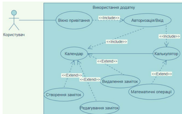
Рисунок 4.1 – Схема взаємодії користувача з додатком
